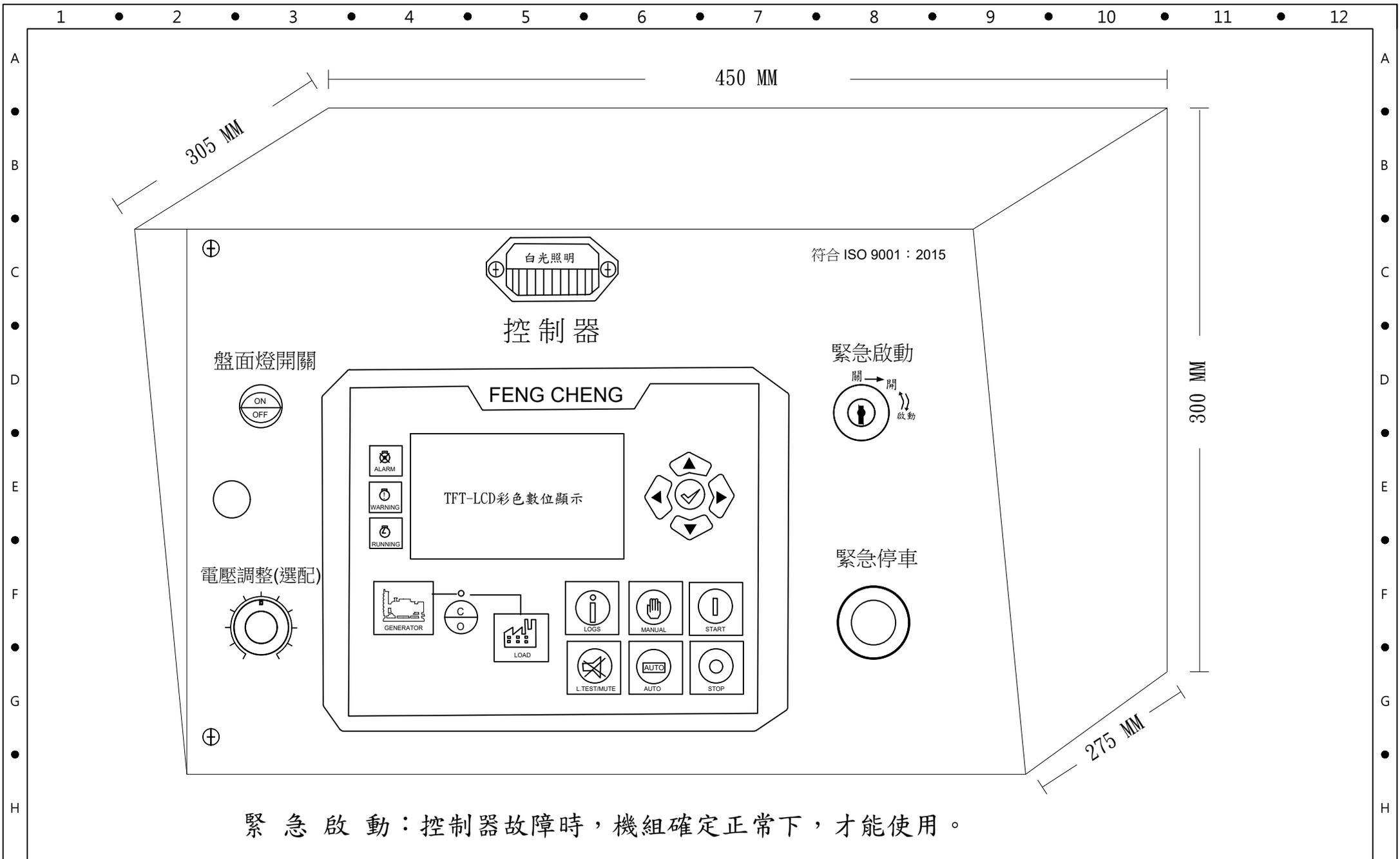
緊急啟動：控制器故障時，機組確定正常下，才能使用。
